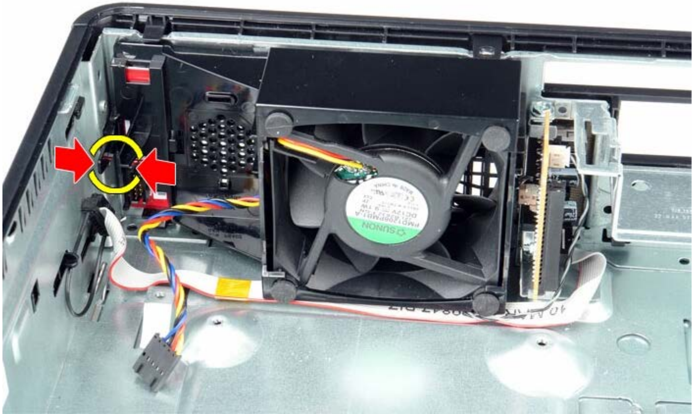
1 11 往前斜拉出風扇，並將其從電腦機箱卸下。
