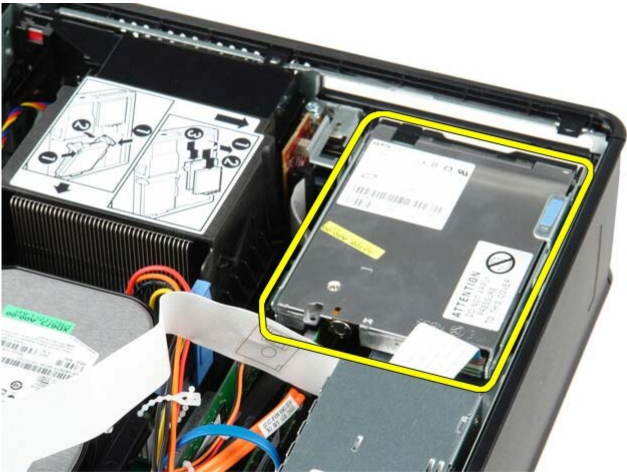
1 11 從電腦提起並取出軟式磁碟機。
