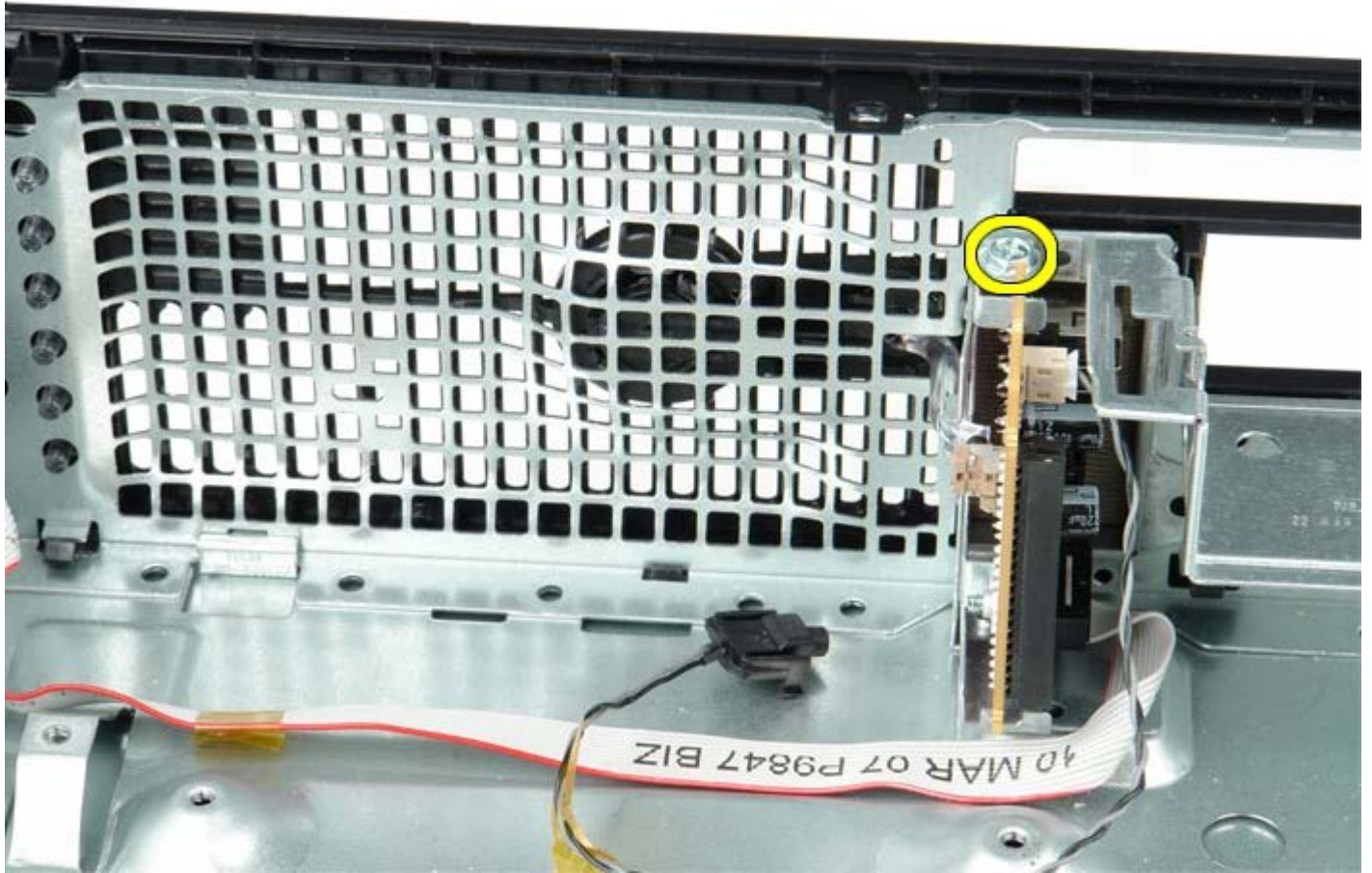
1 11 前後搖動 IO 面板，將圓形彈片從機箱孔鬆開。卸下 IO 面板。
