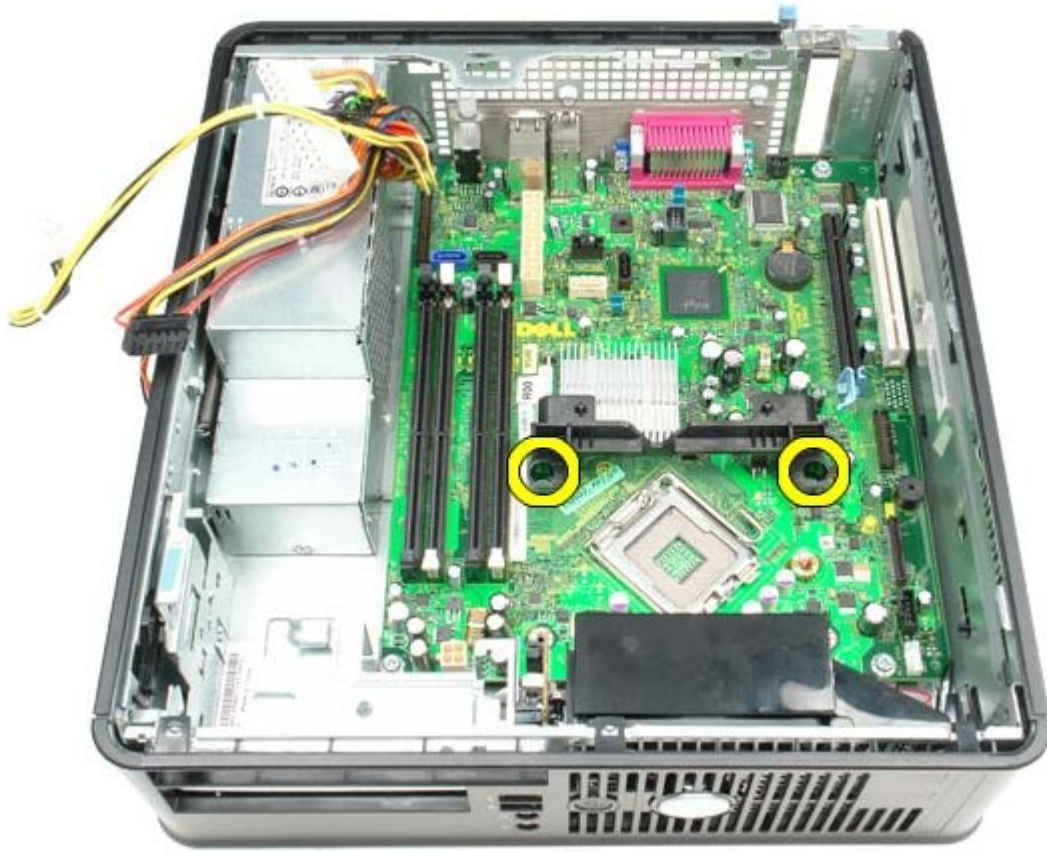
1 1 11 卸下散熱器固定模組。
