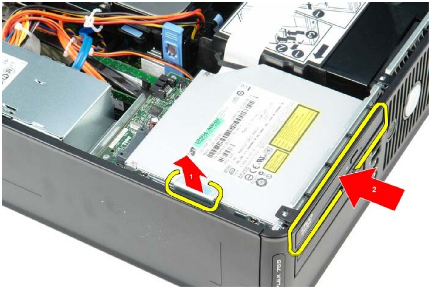
1 11 從電腦提起並取出光碟機。
