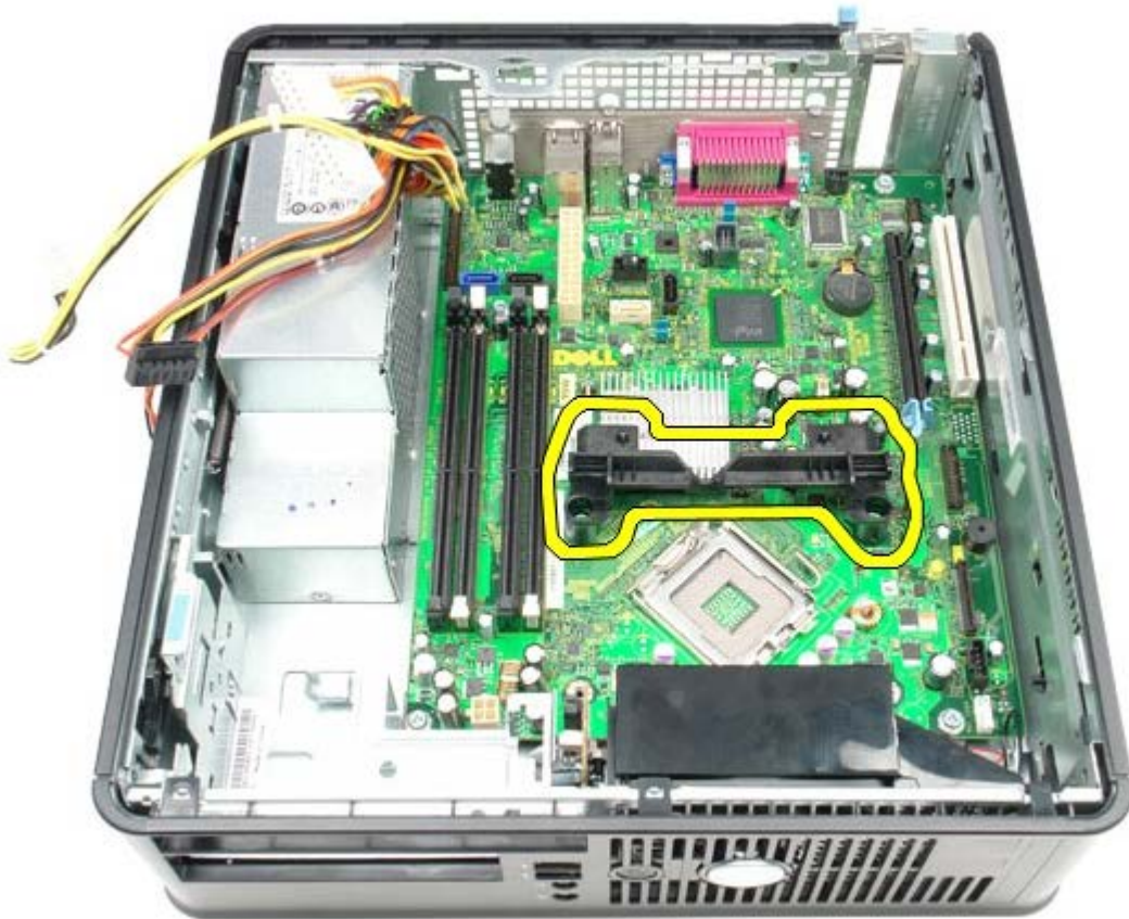
1 1 11 卸下將主機板固定到電腦機箱的螺絲。
