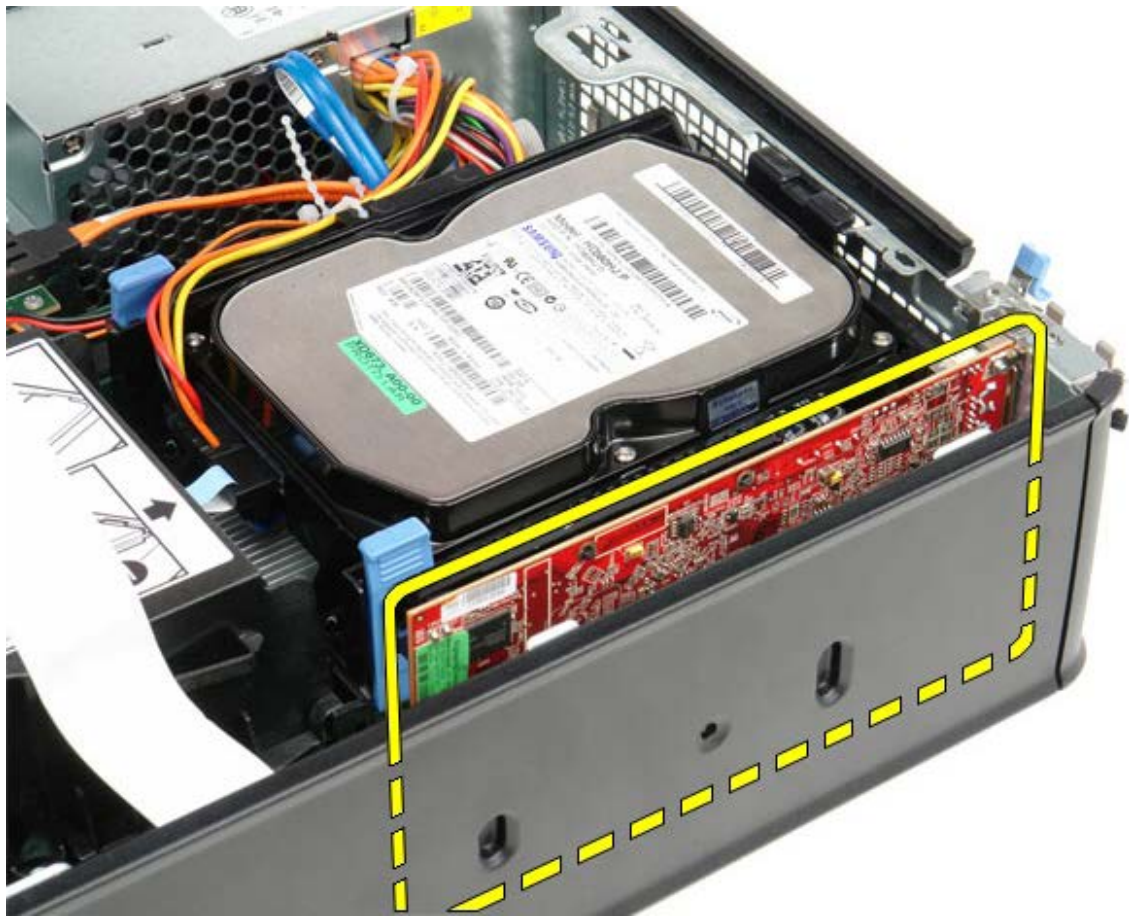
1 11 握住插卡的頂端邊角，將其從連接器中輕輕拔出。
