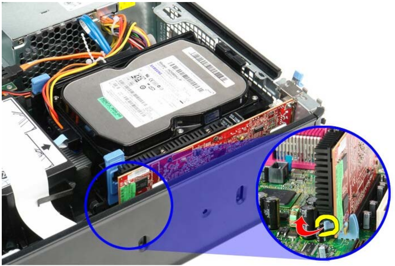
1 11 握住插卡的頂端邊角，將其從連接器中輕輕拔出。
