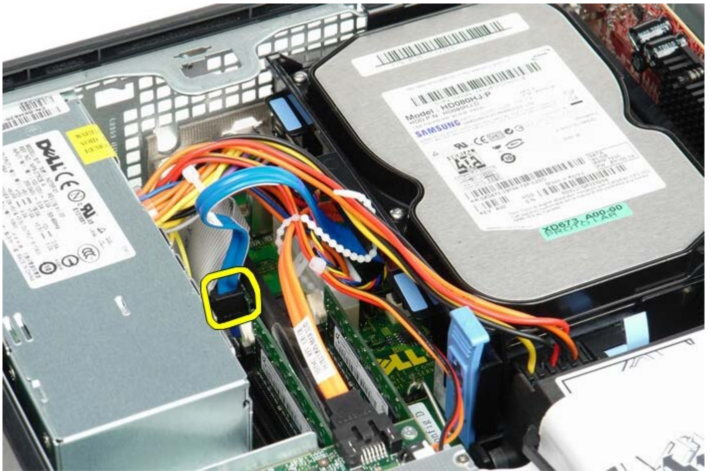
1 11 向內按壓硬碟機盒兩側的藍色固定彈片，然後將硬碟機盒向上滑出電腦。
